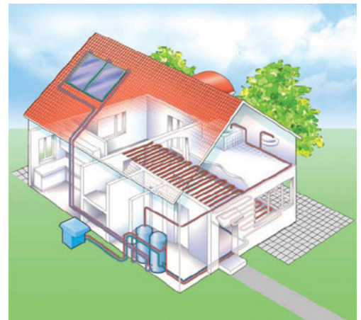
Prinsippet for en uteluft/vann-varmepumpe (Envirotherm)
